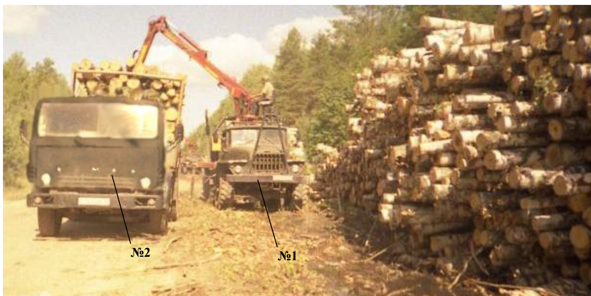
Рис. 2. Выгрузка сортиментов на разгрузочном пункте: №1 – Урал-4320+ТМЗ-802 + ОМТЛ-70-02 (гос. номер В 036 СК); №2 – КамАЗ-5320 + СЗАП-83571 (гос. номер В 042 СК)
