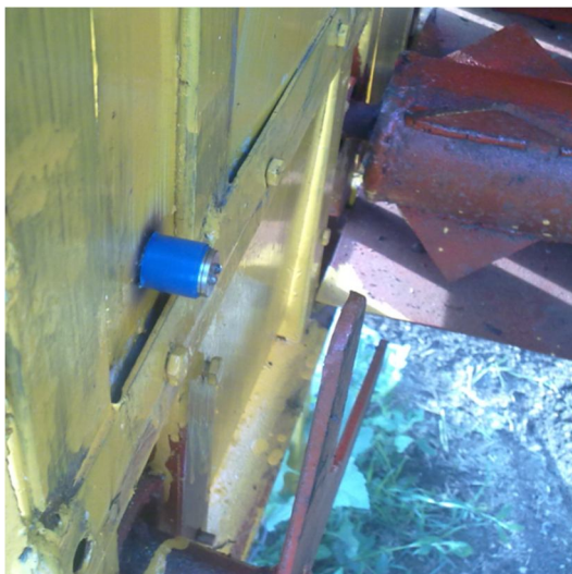
Рис. 3. Вид закрепленного бесконтактного оптического датчика для измерения числа оборотов
