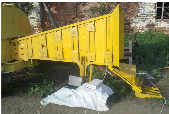
Рис. 2. Общий вид лабораторной установки для изучения технологических параметров устройства для измельчения порубочных остатков
