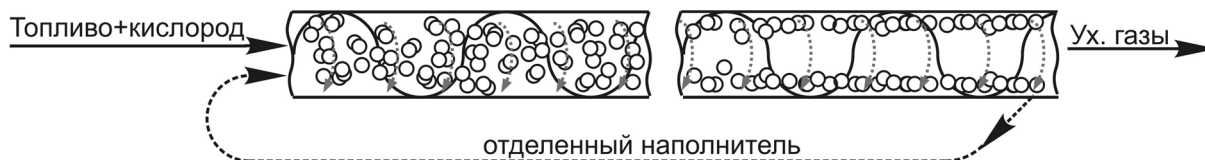
Рис. 5. Схема функционирования каталитической системы с перемещаемым каталитическим наполнителем с поперечным отделением от потока
