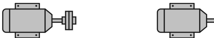
Рис. 3. Схема определения момента инерции ротора асинхронного электродвигателя с учетом потерь на трение в его опорах
