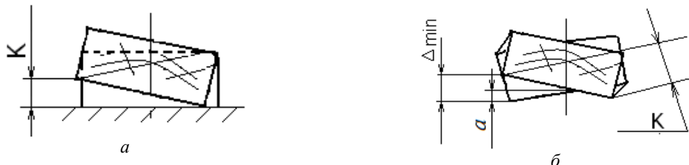
Рис. 4. Совмещенная схема измерения K и a : а – схема измерения по ГОСТ 2140–81; б – схема для расчета a и K ; a – стрела прогиба по ГОСТ 10294–90, \Delta_{\min} – минимальный припуск на обработку каждой поверхности при симметричном базировании заготовки, K – крыловатость заготовки (по ГОСТ 2140–81)
