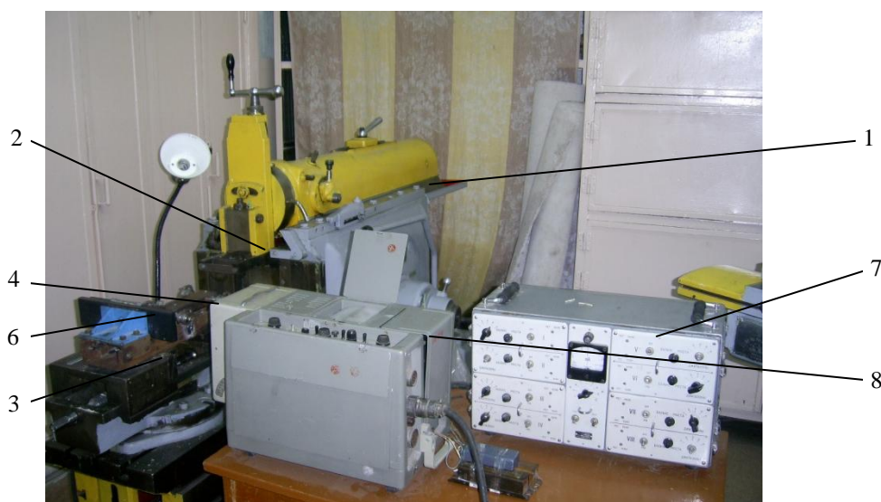
Рис. 1. Стенд для проведения экспериментов: 1 – горизонтально-строгальный станок; 2 – режущая головка; 3 – направляющая; 4 – каретка; 6 – тензометрическая балка; 7 – усилитель; 8 – осциллограф
