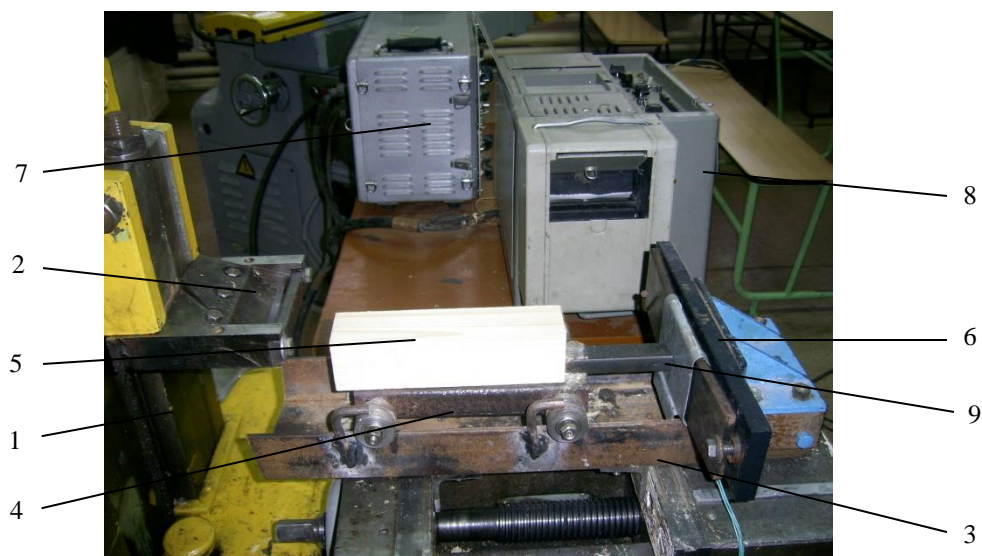
Рис. 2. Процесс строгания древесины на шпон: 1 – горизонтально-строгальный станок; 2 – режущая головка; 3 – направляющая; 4 – каретка; 5 – заготовка; 6 – тензометрическая балка; 7 – усилитель; 8 – осциллограф
