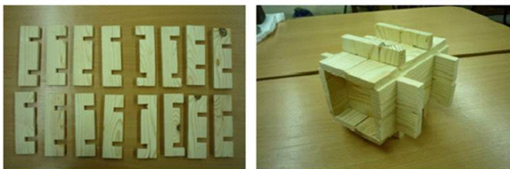
Рис. 1. Общий вид сборной коробки: а – элементы сборной коробки (деревянный стержень); б – деревянная коробка в сборе
