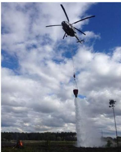
Рис. 2. Водосливное устройство ВСУ-5А в комплекте с СДП-1 (фото Ерицова А. М.)
