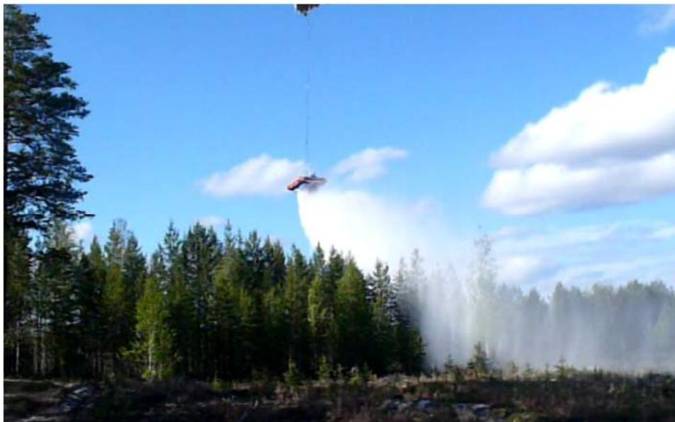
Рис. 6. Создание противопожарной заградительной полосы огнестойкой быстротвердеющей пеной с применением ВВСУ УКТП «ПУРГА» (фото Ерицова А. М.)
