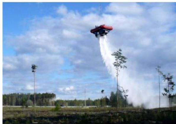
Рис. 5. Слив быстротвердеющей огнестойкой пены на контрольно-измерительный полигон (фото Гусева В.Г.)
