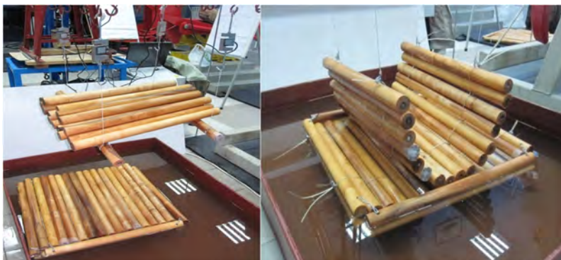
Рис. 5. Подъём первого ряда плоской сплочной единицы: слева – конструкция АГТУ; справа – конструкция ПГТУ
