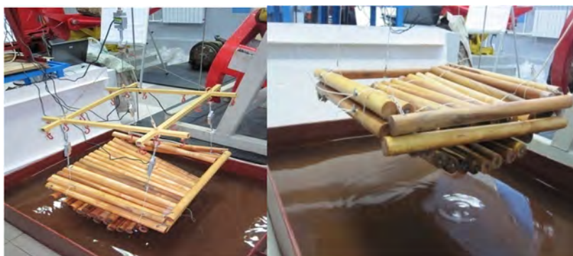
Рис. 6. Подъём двух рядов плоской сплочной единицы: слева – конструкция АГТУ; справа – конструкция ПГТУ
