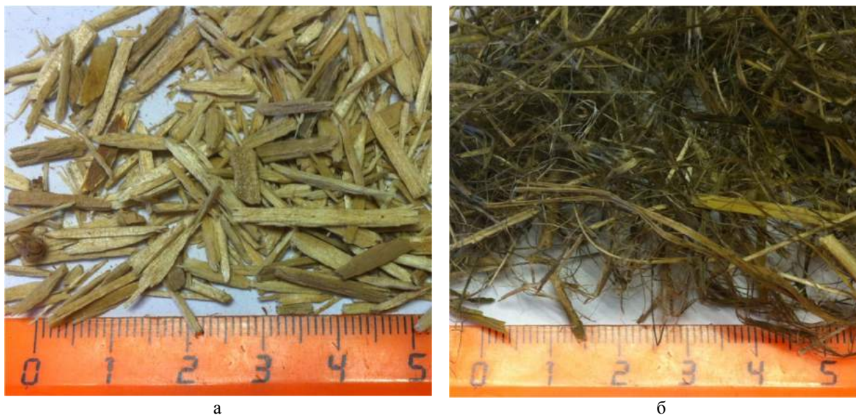
Рис. 1. Внешний вид наполнителя древесно-стружечных плит: а – древесные частицы; б – очёс
