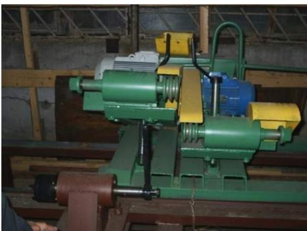
Рис. 1. Общий вид обрабатывающего узла со стороны фрезерных головок (фрезы сняты)
