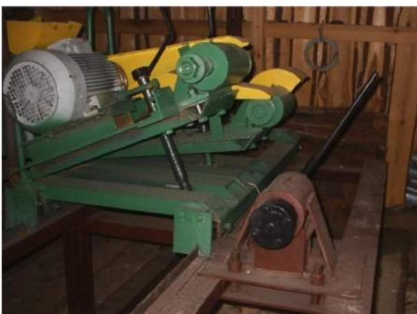
Рис. 2. Вид обрабатывающего узла со стороны маятника фрезы для чистой обработки бревна
