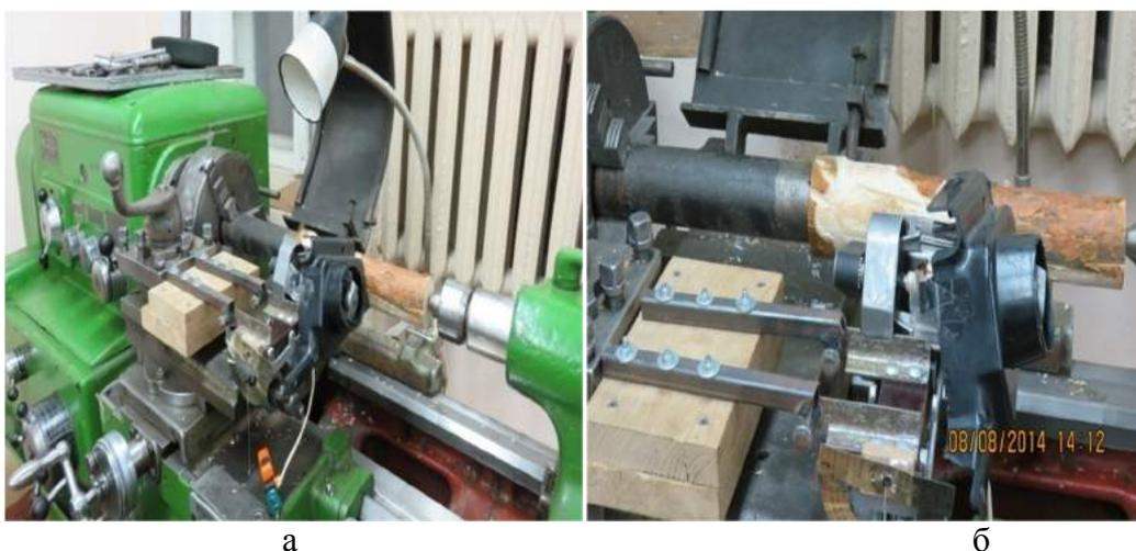
Рис. 4. Общий вид экспериментальной установки для исследования процесса оцилиндровки брёвен:
