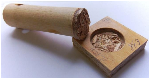
Рис. 5. Характерное разрушение образца фанеры при отрыве
