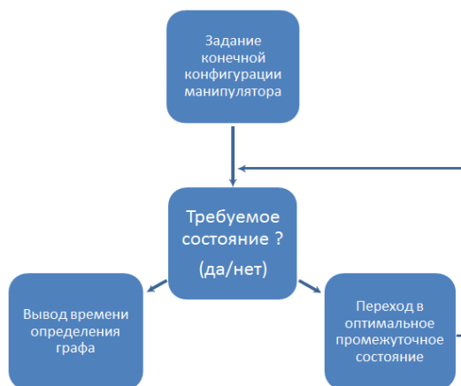
Рис. 2. Алгоритм работы системы контроля конфигурацией манипулятора
