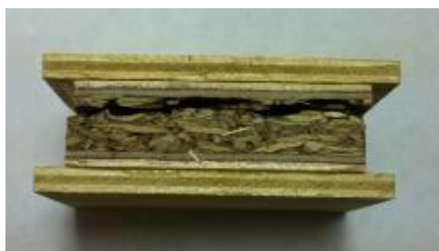
Рис. 4. Характер разрушения образцов при отрыве перпендикулярно к пласти
