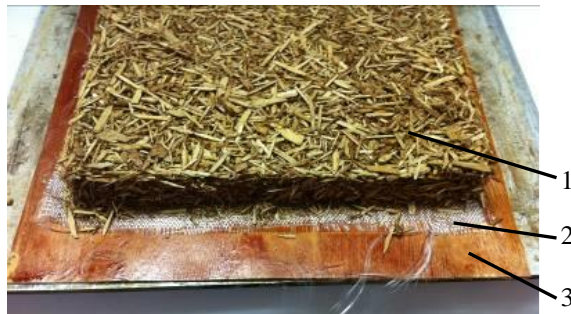
Рис. 1. Часть пакета композиционной фанеры до запрессовки: 1 – слой древесно-клеевой композиции; 2 – стеклоткань, 3 – шпон с нанесённым клеем
